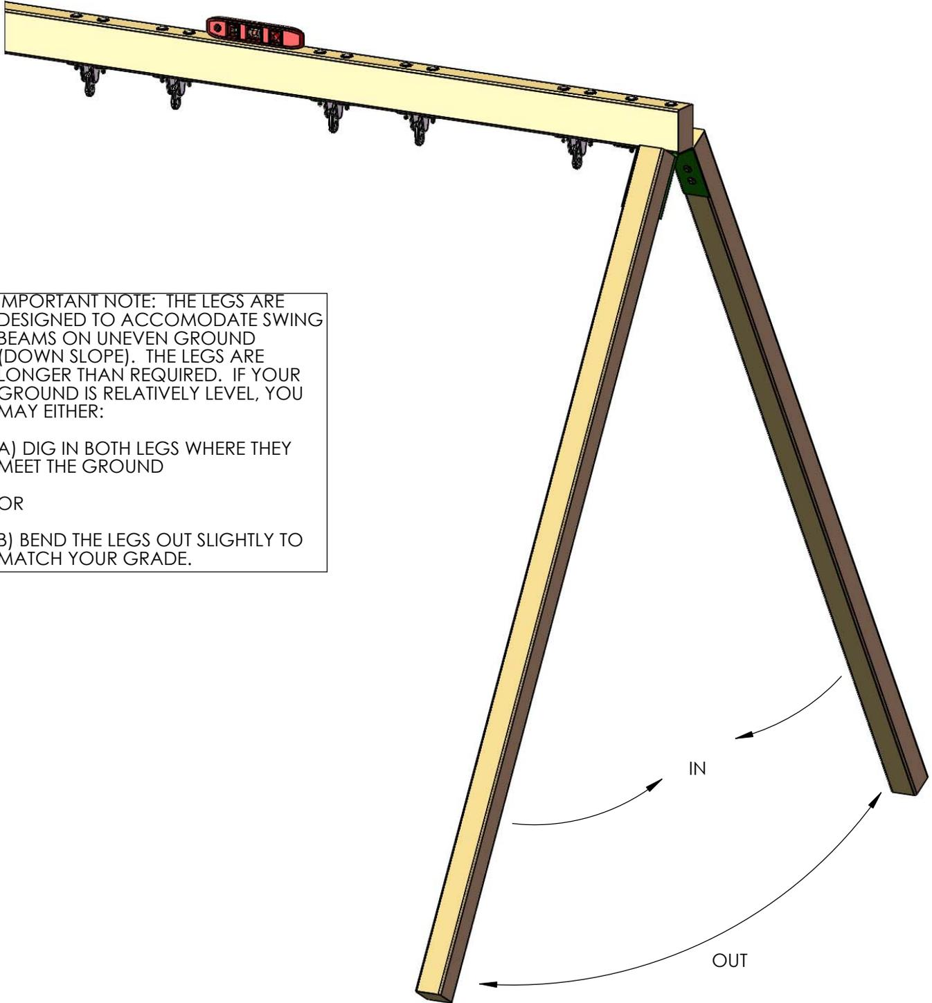
IMPORTANT NOTE: THE LEGS ARE DESIGNED TO ACCOMODATE SWING BEAMS ON UNEVEN GROUND (DOWN SLOPE). THE LEGS ARE LONGER THAN REQUIRED. IF YOUR GROUND IS RELATIVELY LEVEL, YOU MAY EITHER:
